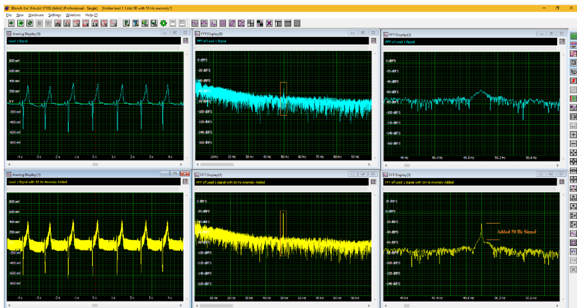
図5：リード1ホルター信号への50 Hz 干渉信号の追加
