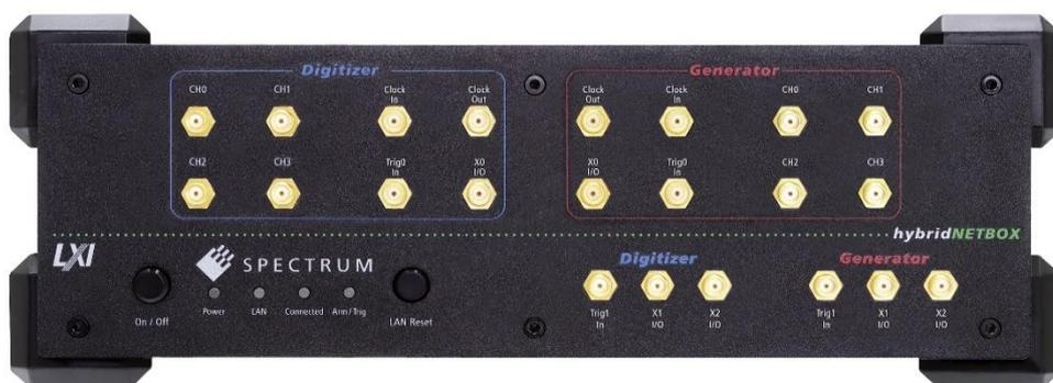
例 : hybridNETBOX のモデル DN2. 825-04 は、16 ビット分解能で最大 625 MS/s のレートで波形を出力できる 4 チャンネルの AWG と、14 ビット分解能で 500 MS / s で信号をサンプリングできる 4 チャンネルのデジタイザを提供します
