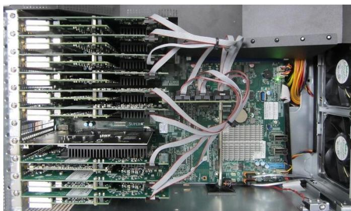
上面図： PC 上の 9 枚の M2p カードが、Star-Hub モジュール（中央）の助けを借りて同期されています。スターハブは、エクステンションまたはトップマウント（2 スロット幅になります）としてカードにマウントできます
