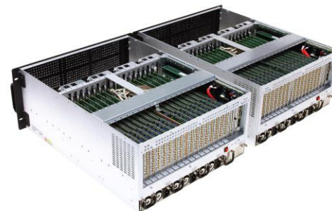
256チャネルシステム 2台の19インチシャーシ/に32台のデジタイザカード
