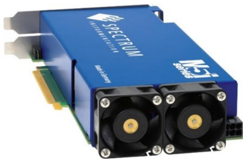
画像 2、3 : PC から独立した 2 基の強力な冷却ファンが、フロントプレートの穴を通してカードの熱を PC ケースの外へ放出
