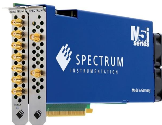
2チャンネル、最大 3.2GS/s、分解能 12 ビットを実現し、12.8GB/s という記録的なストリーミング速度を誇る新型モデル「M5i.3321-x16」
