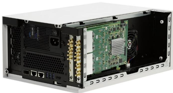
画像 2: 信号生成と 125MS/s の速度での 8 チャンネル信号取得
