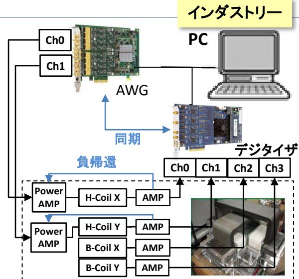
図1. 2次元磁気測定装置
