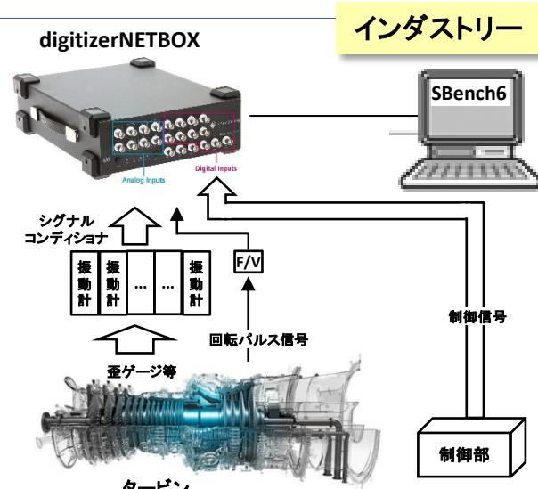
図1. タービンの振動評価装置
