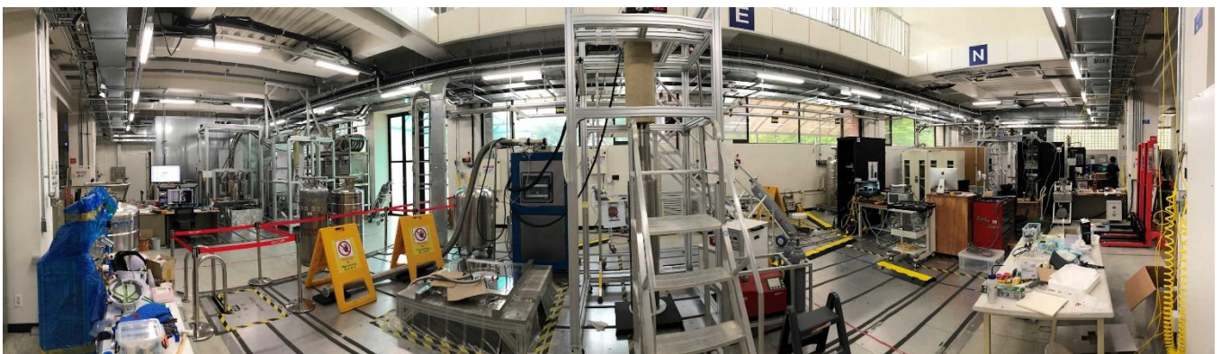
図3 : CAPP 実験ホールでは、複数の暗黒物質探索実験を同時に設置し、運用することができます。実験室には、並列に実験装置を設置するための 7 つの低振動パッドと、複数の冷凍機、超伝導マグネットが設置されています。
