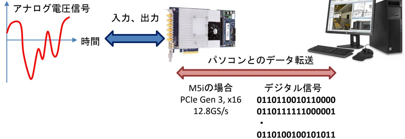
この高速PCIeインターフェースにより、リアルタイムでのデータ収集、データ出力、データ転送、処理、デジタイザとAWGの連携動作が可能となります。
