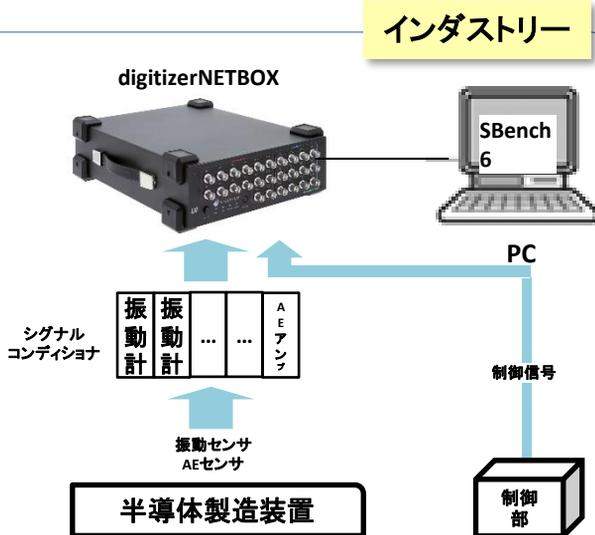
図1. 半導体製造装置の設備診断装置
