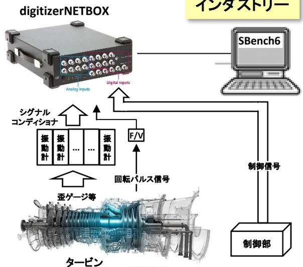
図1. タービンの振動評価装置
