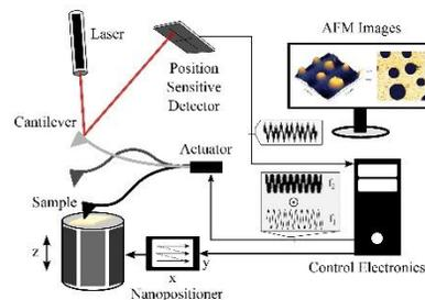
多周波原子間力顕微鏡実験の概略構成
