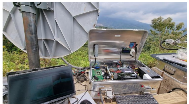
図1：電子装置は、ジャングルの湿気や雨、野生動物から保護するため、金属製の箱に収納されている。
