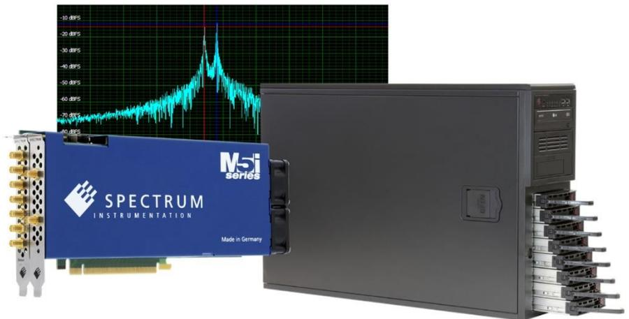
スペクトラム社の M5i.33xx デジタイザは、10GS/s でのデータの取得が可能。COTS 部品で構築されたストリーミング用 PC を介して、分析用の GPU あるいはストレージ用の SSD アレイにデータをノンストップでストリーミングします
