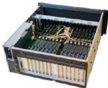
8枚のM2p.5968-x4(合計64デジタイザ・チャネル)搭載のPCと1枚のM2p.6561-x4(2AWGチャネル、下から3枚目)。Star-Hubは、9本の同期-ケーブルがついたデジタイザ・カード(写真の中央)の1枚にエクステンションとして取り付けられます。
