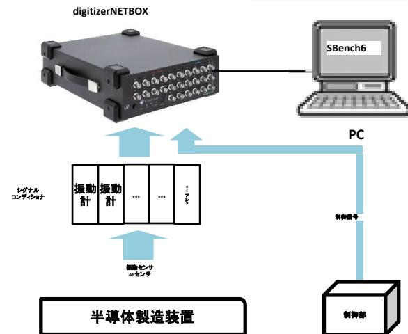
図1. 半導体製造装置の設備診断装置
