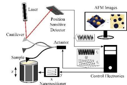
多周波原子間力顕微鏡実験の概略構成
