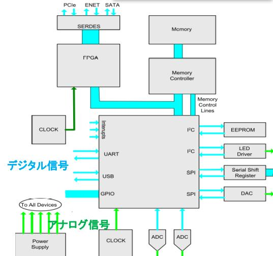
図1 プロセッサー制御機器
