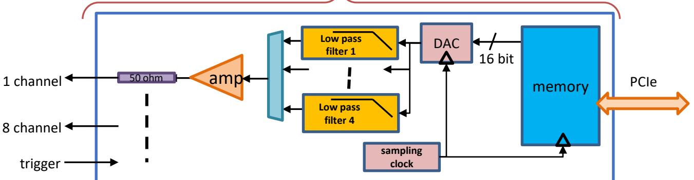
パソコンからのプログラミング、付属のGUI "SBench6"からの設定により、AWGから任意のアナログ波形を生成し、測定対象に印加することができます。
