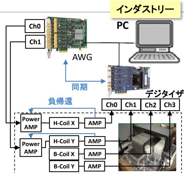
図1. 2次元磁気測定装置
