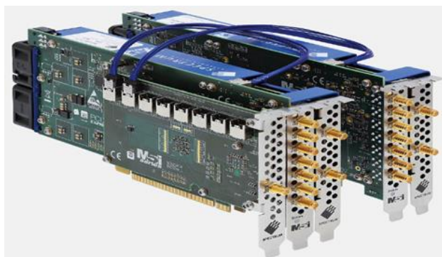
図 2 Star-Hub オプションを使用すると、共通のサンプリングクロックとトリガソースを共有することで、最大 8 つのデジタイザを同期できます。
