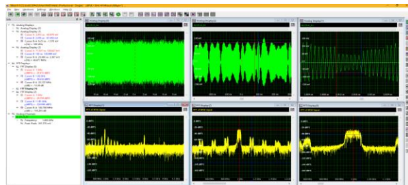
左上 取得された8PSK信号 右側 その水平方向のズーム 左下 信号のスペクトル 右側 その拡大図
