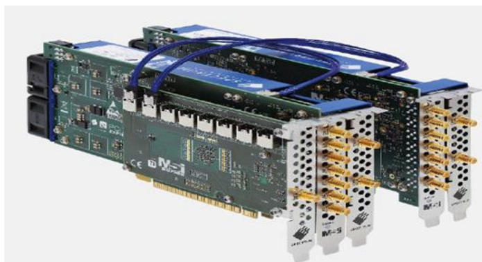
図 2 2 台の M5i シリーズデジタイザの典型的な Star-Hub ペアリング。ピギーバックされた Star-Hub ボードと、トリガ信号とクロック信号を接続する同軸ケーブルセットを示す。
