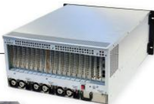
19 インチ 5U システム。18 スロット バックプレーンと 16 個の PCIe スロットを備え、Spectrum カードに使用でき、1 つのシャーシで最大 256 チャンネルを実行できます
