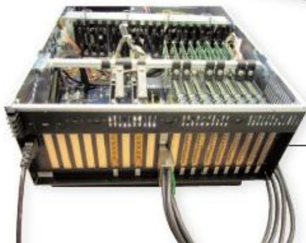
外部 16 スロット PCIe ドッキングステーション。標準 PC 用の拡張ボックスで、16 個の PCIe スロットを任意のホストシステムに導入できます
