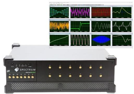
新しい DN6.33x デジタイザ (12 ビット) は、6 チャンネルで最大 10 GS/s、または 12 チャンネルで最大 5 GS/s の性能を提供します。
